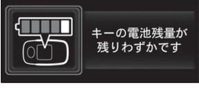
キーの電池残量が残りわずかです                | 電子カードキーの電池切れが近いときにエンジンスイッチを“OFF”にした※2<br>・警告ブザーが鳴ります。<br>→ <b>新しい電池に交換する (→ P. 216)</b>                                                 |
