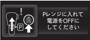
プレンジに入れて電源をOFFにしてください         | シフトレバーがP以外の状態でエンジンスイッチを“OFF”にしようとした<br>→ <b>シフトレバーをPにする</b>                                                                             |
