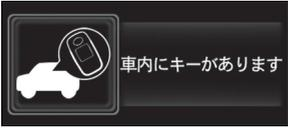
車内にキーがあります                      | エンジンスイッチが“OFF”のときに、車内に電子カードキーを置いたまま、すべてのドアが施錠されている状態で運転席以外のドアのロックレバーを解錠側にして、ドアを開けて閉めた<br>→ <b>電子カードキーを携帯して施錠する</b>                      |
