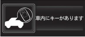
車内にキーがあります                      | エンジンスイッチが“OFF”のときに、車内に電子カードキーを置いたまま、運転席ドアを開き、ロックレバーを施錠側にしてドアハンドルを引いたままドアを閉めて施錠しようとした<br>→ <b>車内から電子カードキーを取り出したあと、再度施錠する</b>             |
