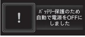
バッテリー保護のため自動で電源をOFFにしました        | 自動でエンジンスイッチが“OFF”になった<br>・エンジンスイッチが“ACC”のときは1時間以上、“ON”のときは20分以上経過すると表示されます。<br>→ <b>次回エンジン始動時にエンジン回転数を少し高めにし、約5分間その回転を保持しバッテリーを充電する</b> |
