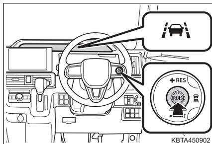
車線中央付近を走行中に作動条件 (→ P. 160) をすべて満たすと LKC が作動します。
