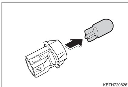
5 新しい電球を取り付け、ソケットを回してレンズに取り付ける
