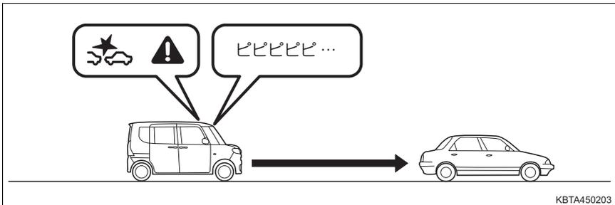
前方車両\*・歩行者を認識して、衝突の可能性が高いと判断したときに、ブザーを変化させブレーキ制御を行います。
