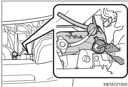
6 エンジンを始動し、エアコンを作動させてラジエーター冷却用のファンが作動しているか、およびラジエーターコアやホースなどから冷却水漏れがないことを再度確認する
