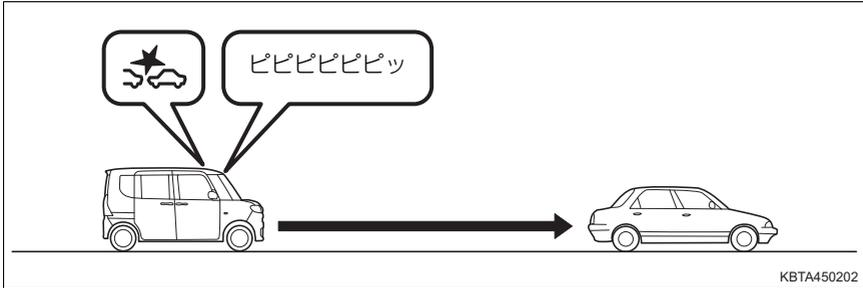
前方車両\*・歩行者に対し、衝突の危険性があると判断したときに、ブザーとディスプレイの表示（→ P. 117）で運転者に注意喚起して衝突回避操作を促します。
