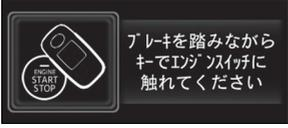
ブレーキを踏みながらキーでエンジンスイッチに触れてください   | 電子カードキーを携帯していない状態で2回エンジンをかけようとした<br>→ <b>電子カードキーを携帯する※1</b>                                                                             |
