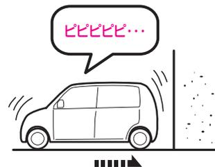
車速が約 4km/h 以下で、アクセルペダルが必要以上に踏み込まれたと判断したときに、ブザーとメーター表示で警報し、運転者に衝突回避操作を促します。
