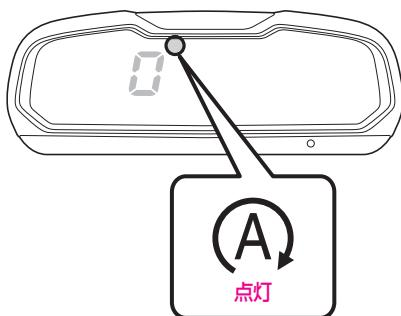
**2** “D”レンジのままブレーキペダルを踏み減速すると、停車前（約 11km/h 以下）もしくは停車後に、アイドリングストップします。
