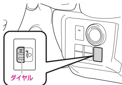
ダイヤルを回すと、ヘッドランプの光軸が上下に変わります。
