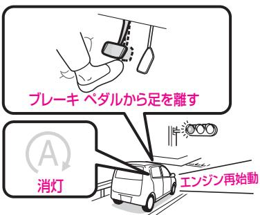
**4** しばらく走行して、再びアイドリングストップする条件を満たすと、eco IDLE 表示灯が点灯します。
