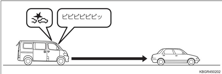
前方車両※・歩行者に対し、衝突の危険性があると判断したときに、ブザーとディスプレイの表示（→ P. 150）で運転者に注意喚起して衝突回避操作を促します。
