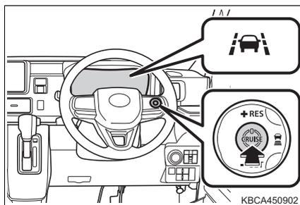
車線中央付近を走行中に作動条件（→ P. 151）をすべて満たすと LKC が作動します。
