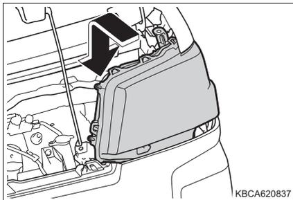
17 ヘッドランプのクリップ (①) とボルトを (②) を取り付ける
