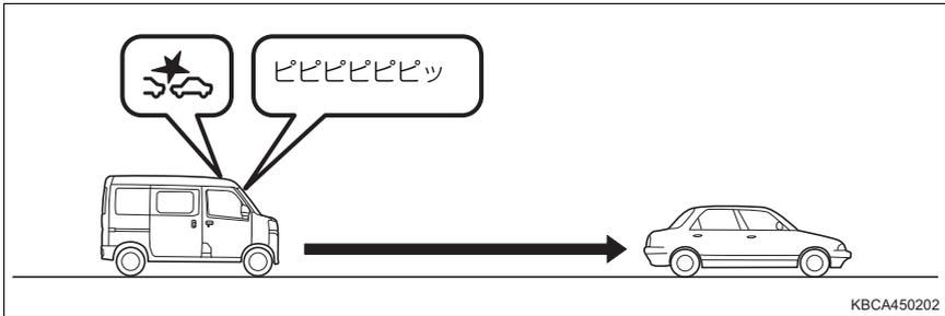
前方車両※・歩行者に対し、衝突の危険性があると判断したときに、ブザーとディスプレイの表示（→ P. 108）で運転者に注意喚起して衝突回避操作を促します。
