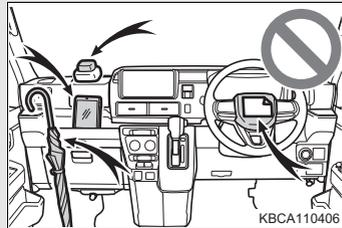
● SRS エアバッグシステム構成部品の周辺は、強くたたくなど過度の力を加えないでください。
