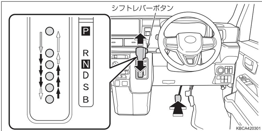
← : エンジンスイッチが“ON”の状態、ブレーキペダルを踏んだままシフトレバーボタンを押して操作します。
