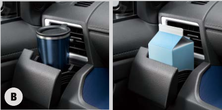
回転式カップホルダー (運転席/助手席) 角型バック、ペットボトルなどの丸型に対応。 閉じればスマートフォン立てにも使用可能。
