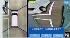
駐車枠検知を開始しますので、検知した駐車枠が正しければ「はい」を押す。
