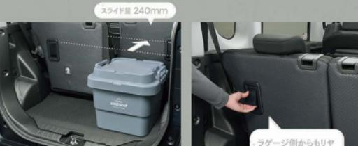
ラゲージ側からもリヤシートのスライド操作が可能。側面に回り込む必要がなく、荷物の積載がより便利に。
