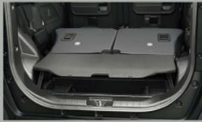
リヤシートパック・デッキボード(上段モード:耐荷重20kg)
