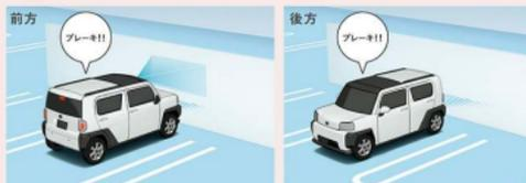
前方約4m以内に障害物等があることをステレオカメラまたは約2〜約3m以内に障害物等があることをソナーセンサーが検知している時に、シフトポジションを[D]、[B]、[S]にしたままブレーキペダルを踏み込んだ場合、急発進を抑制します。
