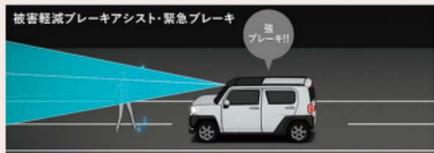
事前ブレーキが作動している時にドライバーがブレーキペダルを踏み込むと、ブレーキアシストが作動し、ブレーキ制動力を高めます。衝突が避けられないとシステムが判断した場合、強いブレーキで減速。衝突の回避や、被害の軽減をサポートします。
