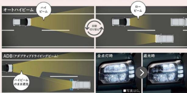
〈オートハイビーム〉 ■ 自車速度約30km/h以上で作動します。 ■ ハイビーム・ロービームの切り替え自動制御には状況により限度があります。運転時には常に周囲の状況に注意し、状況に応じて手動で切り替えるなど、安全運転を心がけてください。 〈ADB(アダプティブドライビングビーム)〉 ■ ADB=Adaptive Driving Beam ■ 自車速度約30km/h以上で作動します。 ■ 次のような場合は、ハイビームが自動で遮光ビームに切り替わりません。 ● 対向車の悪いカーブで対向車と交差する直前直後時 ● 対向車が前方を横切った時 ● 連続するカーブや中央分離帯、曲路などで前方車両が見え隠れする時 ● 前方車両が離れた車線から接近した時 ● 前方車両が無灯火の時など 詳しくは取扱説明書をご確認ください。 ■ 注意事項については、P28もご覧ください。
