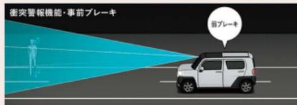
走行中に前方の車両(二輪車、自転車を含む)や歩行者をステレオカメラが検知し、衝突の危険性があると判断した場合、ブザー音とメーター内表示で警告します。衝突の危険性がさらに高まったとシステムが判断した場合、弱いブレーキをかけます。
