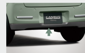
リヤロアガーニッシュ*3 (ガンメタリック) 材質:樹脂(ABS)。
