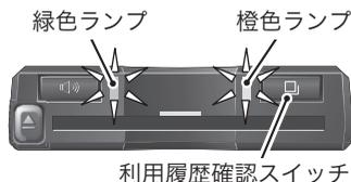
2 ETC2.0車載器の緑色ランプと橙色ランプが点灯中に
