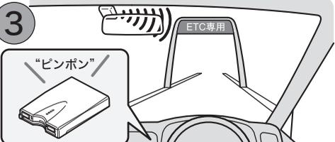
そのまま進むと、ETC2.0車載器と路側アンテナ間で、必要な情報が通信されます。
