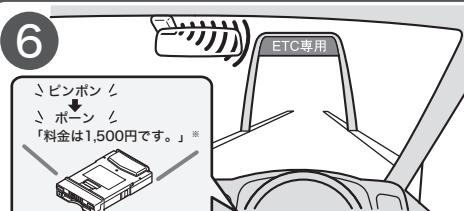
ETC車載器と路側アンテナ間で、精算に必要な情報が通信されます。
