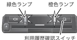
2 ETC車載器の緑色ランプと橙色ランプの点灯中に
