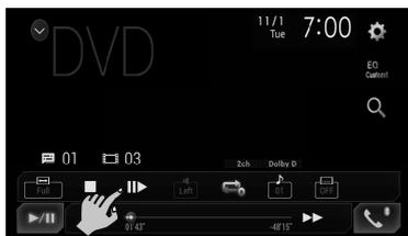
タッチするたびに、映像が1コマずつ進みます。画面に長くタッチすると、送り方向にスロー再生されます。タッチするたびに、再生速度が次のように切り換わります。
