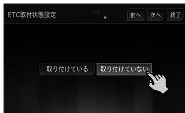
取り付けているに設定すると、機能設定の「スマートIC考慮ルート探索」はONになり、「料金案内」はOFFになります。また、どちらの設定にした場合でも、「ETCレーン案内表示」はONに変更されます。
