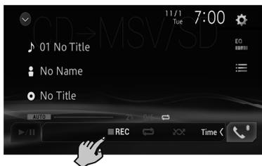
録音を再開する場合は、**REC**にタッチします。すべての曲の録音が完了するまで、選曲操作や特殊再生（ランダム再生など）、タイムバーサーチ再生、早戻し/早送りはできません。操作が必要な場合は、**REC**にタッチして録音を中止してください。
