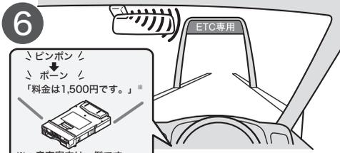
ETC2.0車載器と路側アンテナ間で、精算に必要な情報が通信されます。
