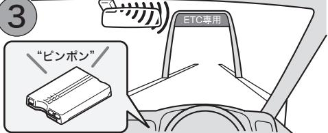
そのまま進むとETC車載器と路側アンテナ間で、必要な情報が通信されます。
