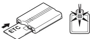
ETC車載器にETCカードを挿入し、アンテナのETCカード挿入確認ランプが点灯していることを確認します。点灯しない場合は、「異常発生時のブザー音/音声案内」を参照してください。(25ページ)
