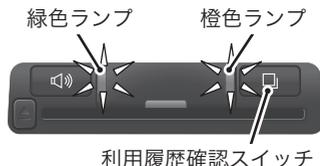
**2 ETC車載器の緑色ランプと橙色ランプが点灯中に [ ] を長押しします。**
