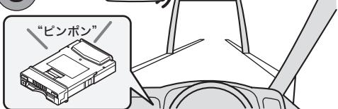
そのまま進むと、ETC車載器と路側アンテナ間で、必要な情報が通信されます。
