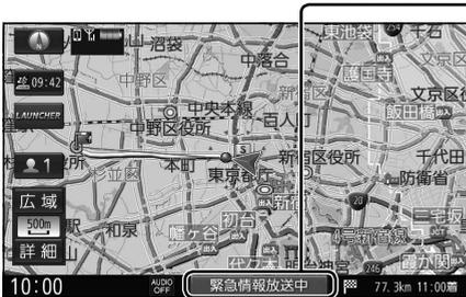
地図画面で情報バーの**緊急情報放送中** を選ぶと、緊急情報画面(詳細情報)が表示されます。
