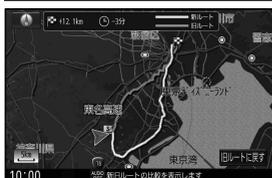
VICS自動再探索が行われた場合は、変更後のルートと変更前のルートを約8秒間表示します。(新旧ルート比較)表示が消えるまで何も操作しないと、変更後のルートで案内を開始します。
