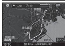
曜日時間規制探索やDRGSで新しいルートが再探索されたとき、変更前のルートも通行できる場合は、変更後のルートと変更前のルートを約8秒間表示します。(新旧ルート比較)
