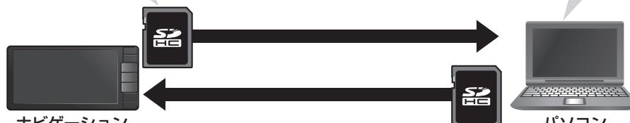
3 地図更新が完了したら、地図SDHCメモリーカードをパソコンから取り出し、ナビゲーションに挿入する。
