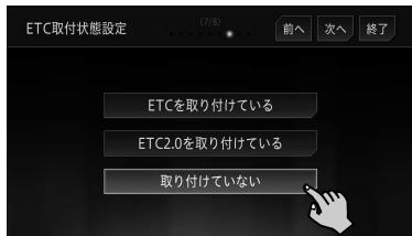
ETCを取り付けているまたはETC2.0を取り付けているに設定すると、機能設定の「スマートIC考慮ルート探索」はONになります、「料金案内」はOFFになります。また、いずれの設定にした場合でも、「ETCレーン案内表示」はONに変更されます。
