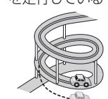
そのまましばらく走行すると、マップマッチングやGPS衛星からの情報を利用して自車マーク位置は自動的に補正されます。
